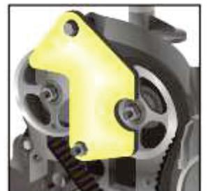
Remova a ferramenta e reinstale a capa plástica da correia dentada. Reinstale a polia da árvore de manivelas e aperte o novo parafuso manualmente. Depois aplique torque 25Nm + 135°.
