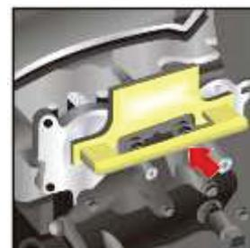
Nos veículos de transmissão manual, retire o sensor de rotação e instale no lugar deste a ferramenta.
