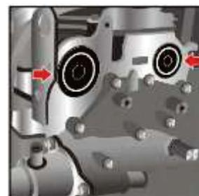
Remova o bujão localizado na lateral direita do bloco (olhando o motor de frente) e no lugar deste, instale o pino rosqueando apenas um pouco.
