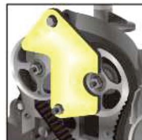
**IMPORTANTE:** Nunca afrouxe ou aperte o parafuso de fixação das polias do comando de válvulas sem travá-la com a ferramenta pois isso pode danificar a ferramenta
