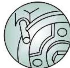
Recoloque a ferramenta 12122 para travar o volante do motor.
