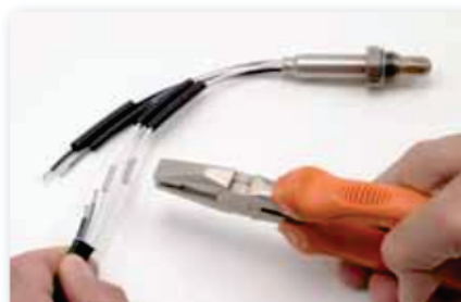
Aperte com um alicate para prender os fios JAMAIS UTILIZE SOLDA!
