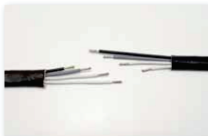
Descasque 5 mm ou 0,5 cm da isolação da Lambda nova e do chicote antigo
