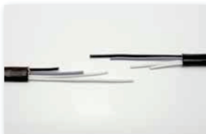
Faça o corte escalonado dos fios da Lambda nova e do chicote antigo
