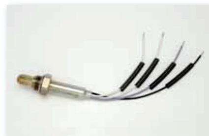
Coloque o termoencolhível nos fios da Lambda
