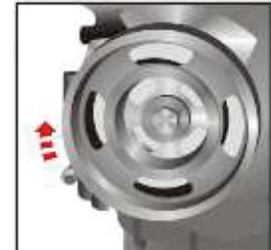
Instale novamente a ferramenta de alinhamento dos comandos para verificar se o sincronismo foi alterado. Em seguida, remova-a e também a ferramenta de alinhamento da árvore de manivelas
