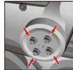
Remova as vela de ignição, depois gire a árvore de manivelas em sentido horário até que o 1º cilindro fique em PMS e coloque a ferramenta de alinhamento dos eixos
