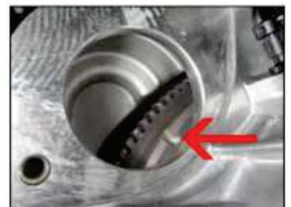
Desconecte o chicote e afrouxe os parafusos do motor de partida, em seguida remova-o.
