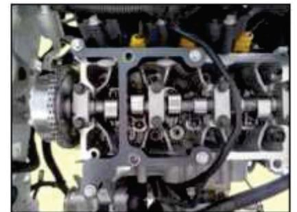
Remova os parafusos os parafusos de fixação de eletroválvula do variador de fase e em seguida, remova a eletroválvula.
