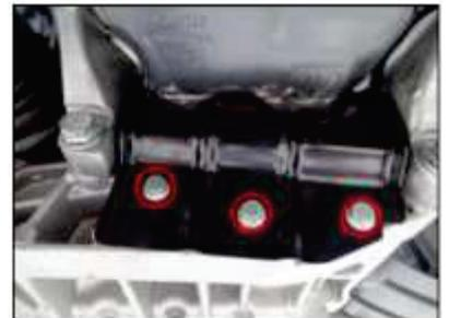
Remova o parafuso de fixação do cárter de óleo do motor.
