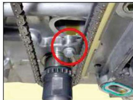
Instale a guia fixa maior e em seguida a guia fixa menor da corrente. Ambas aplicam-se um torque de 9Nm em seus parafusos.
