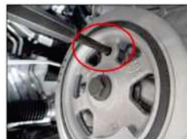
**A polia possui uma massa para contrabalançar o motor, sendo importante a montagem da mesma utilizando um pino guia para alinhamento junto a face da tampa de distribuição. Caso seja montada sem o pino guia, isso gerará vibrações durante o funcionamento do motor.**
