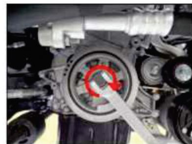
Gire o motor pela árvore de manivelas até que o rasgo no volante do motor esteja visível na sede do motor de partida.
