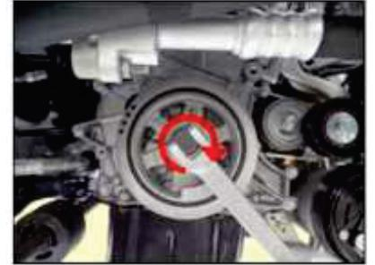
**O parafuso de fixação da polia da árvore de manivelas é rosca esquerda.**
